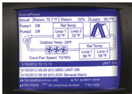
El Liebert MC trabaja con las unidades con compresores Copeland Digital Scroll™ y controles Liebert iCOM, lo cual permite un funcionamiento con velocidad variable para mejorar la eficiencia del enfriamiento y reducir los costos operativos.
